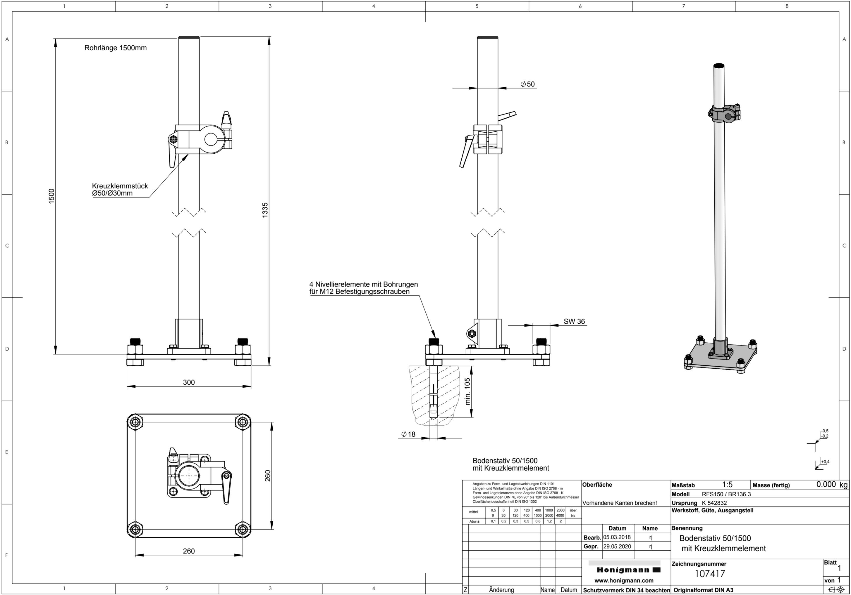
4 Nivellierelemente mit Bohrungen für M12 Befestigungsschrauben
